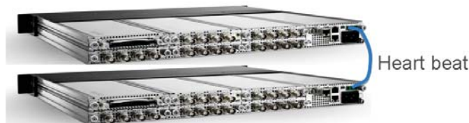
Схема соединения резервирования 1+1.
